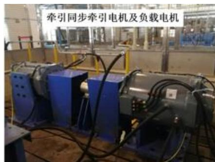
图 8 直驱永磁同步牵引电机对拖控制平台
